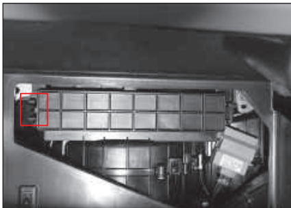
4. Снимите крышку фильтра кондиционера, нажав на правую сторону крышки фильтра кондиционера.
