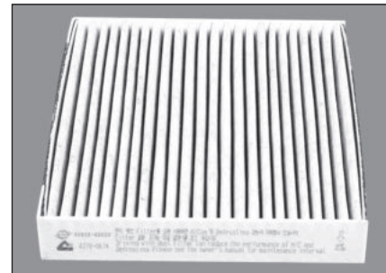
6. Замените фильтр кондиционера на новый. Установите в порядке, обратном снятию.
